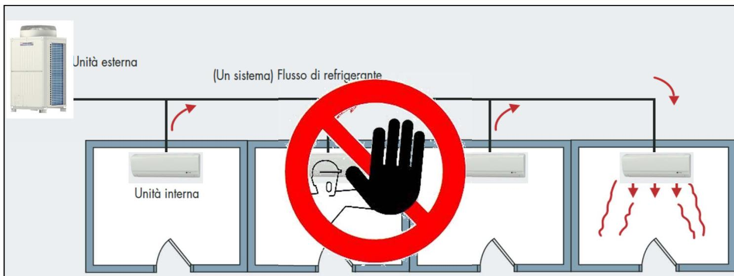
$$\text{Max quantità di refrigerante} \\ = \\ 0.44 \times \text{Volume ambiente climatizzato più piccolo}$$
